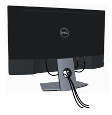
Depois de conectar todos os necessários ao seu monitor e computador, (veja Conectado Seu Monitor para fixação de cabo) organize todos os cabos, como mostrado acima.
